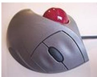
**Trackball:** la idea del trackball parte del hecho de que se debe mover el puntero, no el dispositivo, por lo que se adapta para presentar una bola, de tal forma que cuando se coloque la mano encima se pueda mover mediante el dedo pulgar, sin necesidad de desplazar nada más. Así se reduce el esfuerzo y el espacio necesario.
