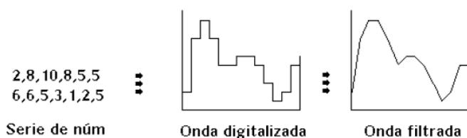
El número de bits empleado para codificar cada muestra es la **resolución de audio**. Hace referencia a la exactitud de las medidas efectuadas. Se mide en bits: si la resolución es de 8 bits tenemos 256 niveles posibles. Es el número de bits para codificar cada muestra.
