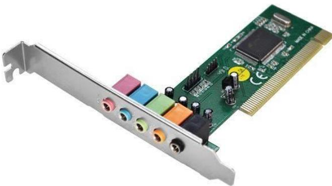
Las conexiones de entrada y salida son un punto importante al que debemos prestar atención. Una tarjeta de sonido puede tener las siguientes conexiones: una entrada de línea, entrada para micrófono, salida de línea, salida amplificada, conector MIDI y conector para Joystick. Las entradas de línea, salida y micrófono suele ser un minijack, un estándar de conexión de sonido de calidad media, que es el comúnmente utilizado en los dispositivos portátiles, como los reproductores de CD.
